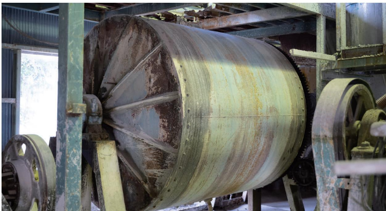
トロンミル。粘土の材料を中に入れてミキサーのように擦る。
